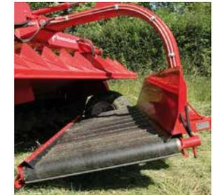
La cinta se suspende hidráulicamente para reducir la tensión en el bastidor y lograr una hilera lo más uniforme posible.
