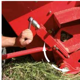
La altura de corte puede ajustarse fácilmente girando completamente la barra de corte hacia arriba o hacia abajo, mejorando así la calidad de la siega en condiciones difíciles.
