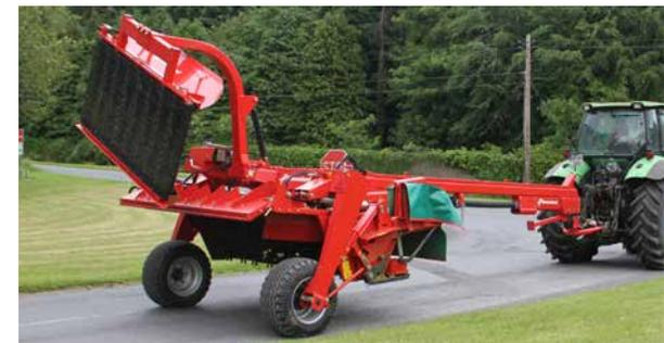
Las versiones CR/CT se centran detrás del tractor en la posición de transporte.
