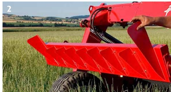
Cambiar de la posición de hilerado a la de henificado es muy fácil. La placa trasera se gira 180°.
