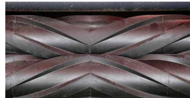
La forma en chevron de los rodillos garantiza un flujo uniforme del forraje en todo el ancho de trabajo.
