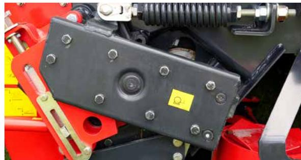
Los 2 rodillos acondicionadores son accionados a cada lado con carcasas lubricadas de bajo mantenimiento.
