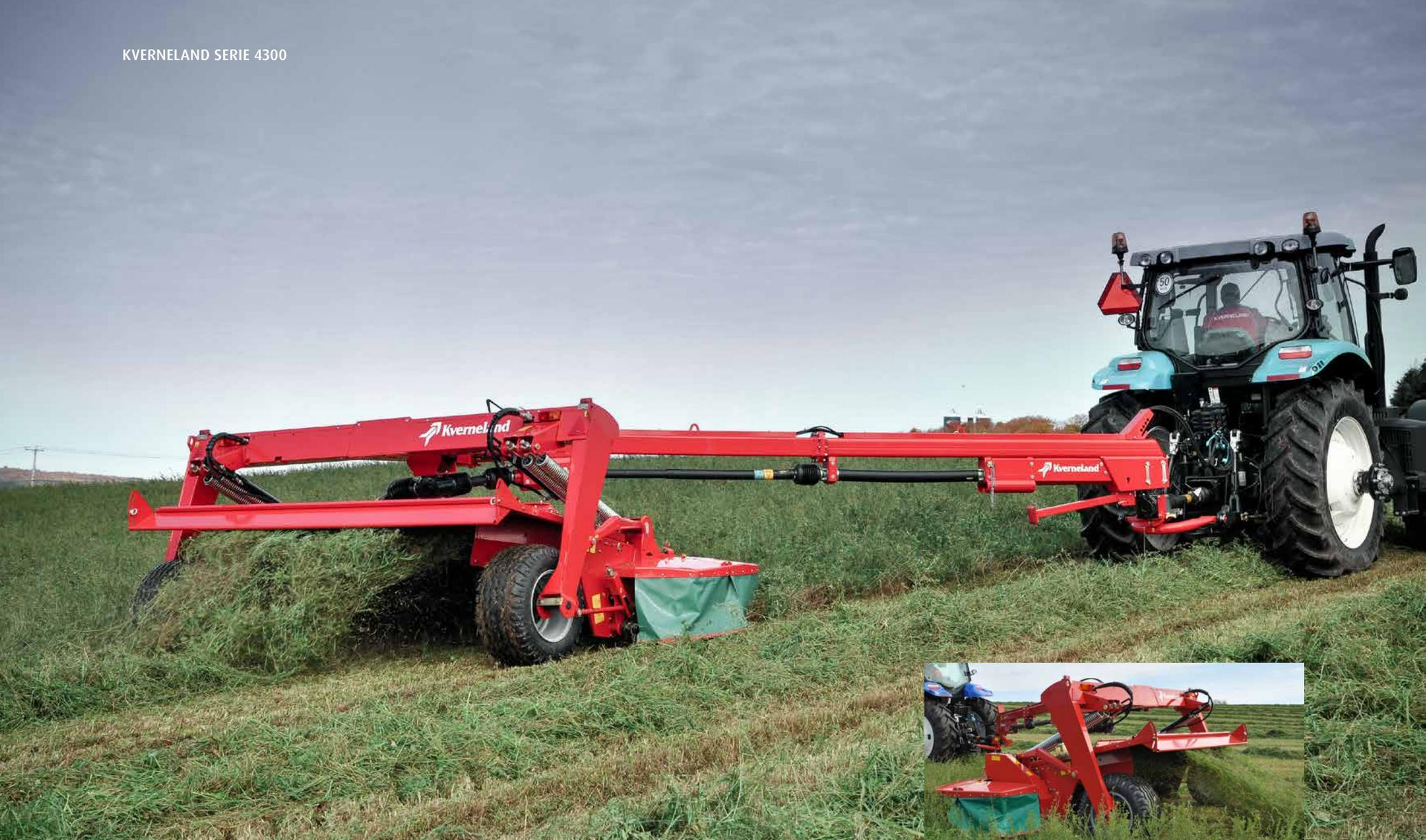
Barra de tiro a la derecha o a la izquierda del tractor - Operada directamente desde la cabina del conductor.
