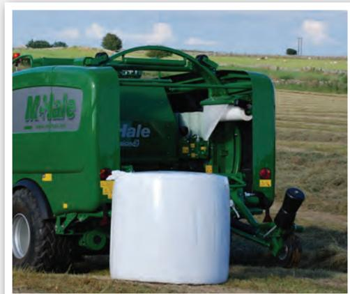
Para descargar la paca, el rodillo trasero de la mesa de encintado baja y la Fusion Vario deposita suavemente la paca encintada en el suelo.
