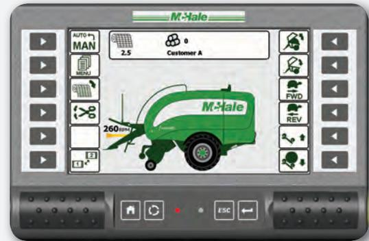
La McHale Fusion Vario es una combinación de rotoempacadora y encintadora completamente automática. El monitor iTouch de control nos indica los parámetros de funcionamiento de la máquina de una forma clara a través de su pantalla táctil de grandes dimensiones.
